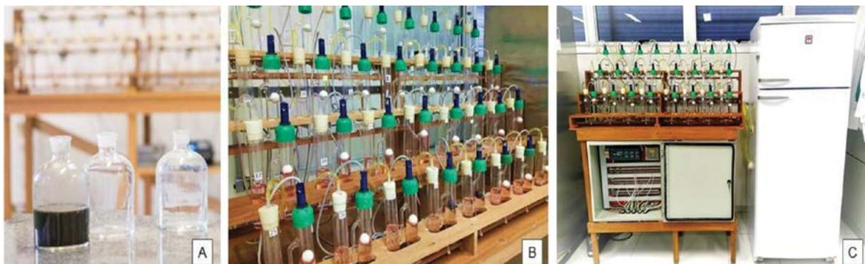
**Figura 1.** SAMB. A - reatores com capacidade de 1L; B - bancada com tubos em forma de “U” conectados aos sensores fotoelétricos; C - Sistema automatizado para medição de biogás composto por bancada suporte para tubos em forma de “U” e sistema de controlador lógico programável (CLP) responsável pelo armazenamento e transferência remota dos dados conectados à incubadora.
