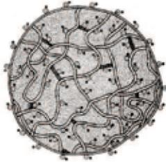
A estrutura final de uma resina catiônica forte (de nosso interesse), obtida da polimerização e sucessiva sulfatação está representada na figura. Os principais grupos funcionais são:
